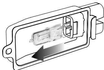
4. Utilisez un chiffon doux pour insérer la nouvelle ampoule. Ne touchez pas à l'ampoule, car l'huile de vos doigts pourrait l'endommager.
