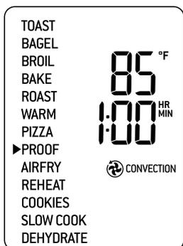
5. Les réglages de température, de temps et de convection peuvent être ajustés avant ou durant le cycle de lever.
