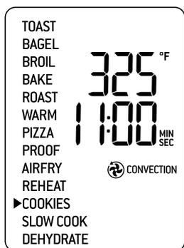
4. Les réglages de température, de temps, de convection et pour aliments congelés peuvent être ajustés avant ou durant le cycle COOKIES (BISCUITS).
