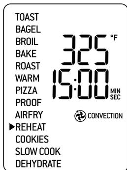
5. Les réglages de température, de temps, de convection et pour aliments congelés peuvent être ajustés avant ou durant le cycle de réchauffage.
