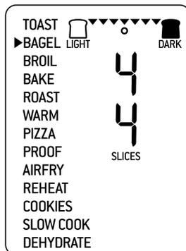
5. Les réglages de coloration et de nombre de moitiés de bagel peuvent être ajustés avant ou durant le cycle de grillage.
