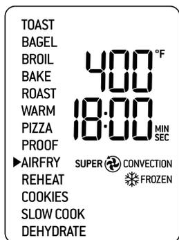
4. Les réglages de température, de temps, de convection et pour aliments congelés peuvent être ajustés avant ou durant le cycle AIRFRY (FRIRE À AIR CHAUD).
