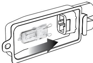
5. Pour remplacer le couvercle en verre, alignez le crochet métallique avec le côté gauche du boîtier. Faites glisser le côté opposé du couvercle en verre dans le support en métal sur le côté droit du boîtier, puis poussez le crochet métallique sur le côté gauche du boîtier jusqu'à ce qu'il s'enclenche en place.
